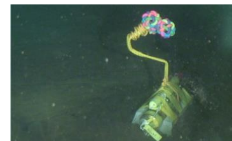
海底に設置した海底水温計
