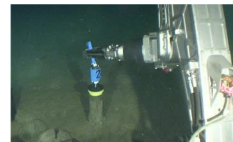
熱物性計測のための堆積物採取
