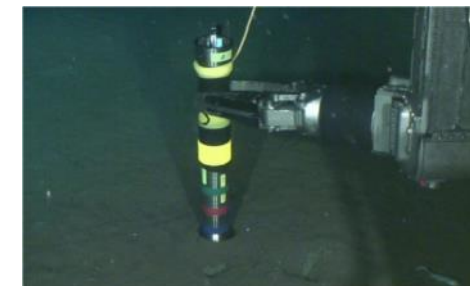
地中温度計の設置
