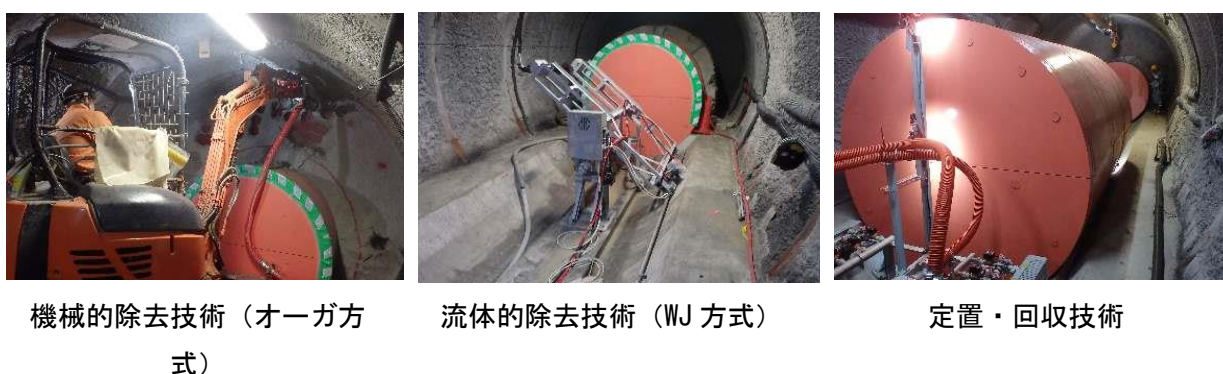
図 2B-33 幌延深地層研究センターにおける横置き・PEM方式の隙間充填材の除去試験
