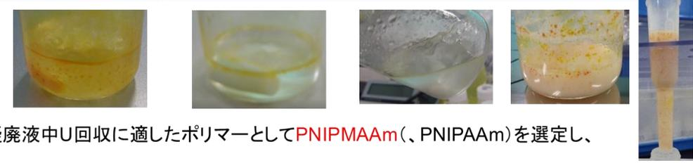
ゲル化抽出による模擬廃液中U回収に適したポリマーとしてPNIPMAAm(、PNIPAAm)を選定し、U回収試験に供した。
