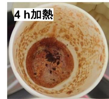
UO<sub>2</sub><sup>2+</sup>-モノアミドゲル化沈殿物の加熱分解挙動
