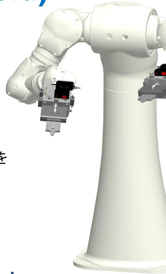
人がこれまで使ってきたツール・機器・装置をそのまま使い作業を行うヒト型ロボット(ヒューマノイド)。
