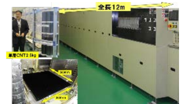
スーパーグロース法による単層CNT製造実証プラント
