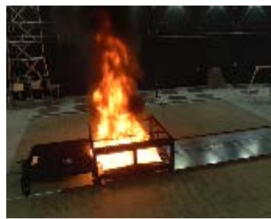
多目的大型実験棟の内部 (蓄電池の燃烧試験の様子)
