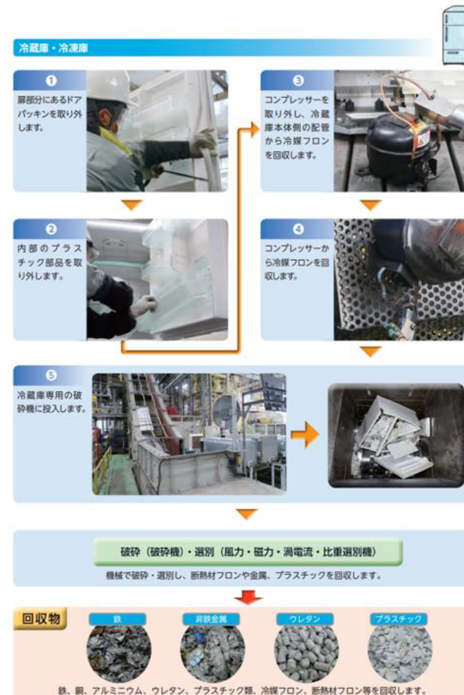
図6：冷蔵庫・冷凍庫の代表的な処理フロー
