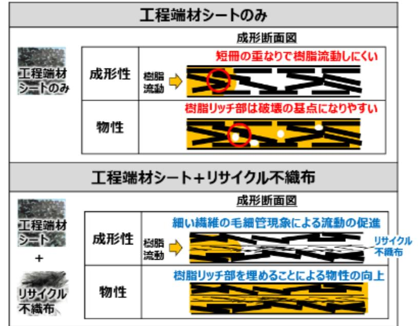
図10.工程端材シート+リサイクル不織布の成形性/物性への影響
