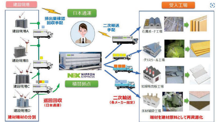
建設副産物巡回回収システム概要図 (大成建設HP)
