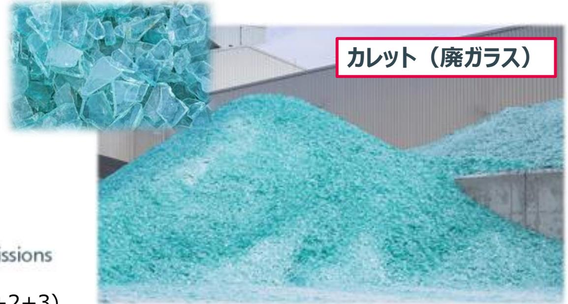
**GHG削減効果：**カレット（廢ガラス）はバージン原料よりも融けやすいことから、燃料の削減に繋がる。また、バージン原料に炭酸塩を使用しており、溶解時にCO<sub>2</sub>が発生するが、カレットを増やすと、炭酸塩の使用量が減少するため、CO<sub>2</sub>の発生を抑えることができる。
