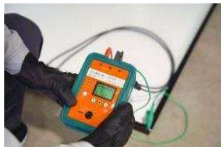
2020・21年度 環境省実証試験にて、ガイドライン準拠の**リユースチェッカー**を開発した。取り外し後のパネルの機能の健全性を**現地で判定可能**
