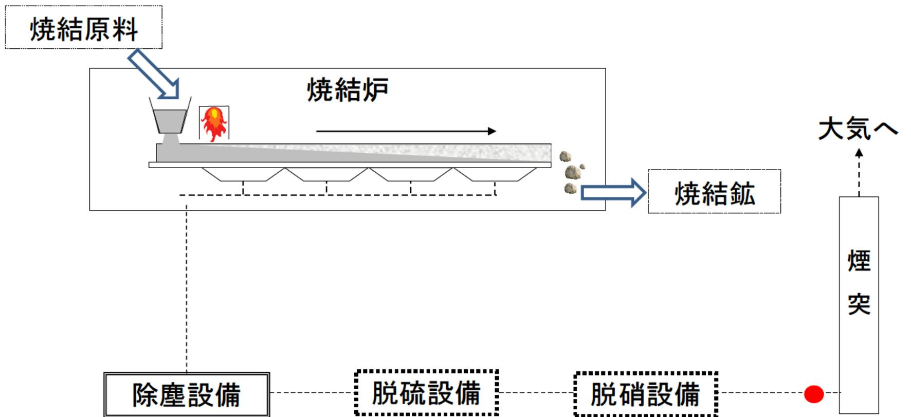
施設の立地条件等により、最適な排ガス処理手法(単体或いは組み合わせ)を実施
