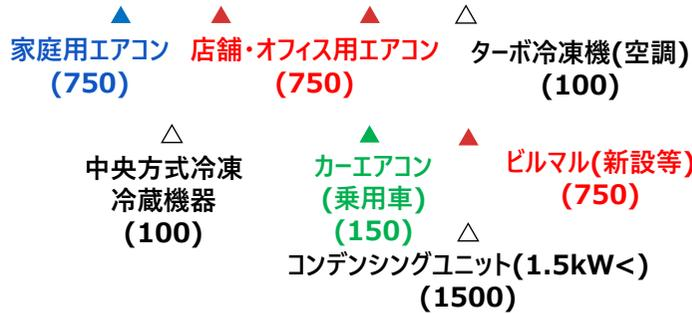
キガリ改正・使用見通しの目標達成のため、出荷される業務用冷凍空調機器・家庭用エアコンに求められるHFC冷媒の加重平均GWP：**450程度**
