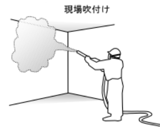
現場吹付けイメージ
