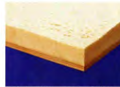
硬質ウレタンフォーム(吹付け) 対象物に直接吹付けて発泡 資料：日本ウレタン工業協会パンフレット
