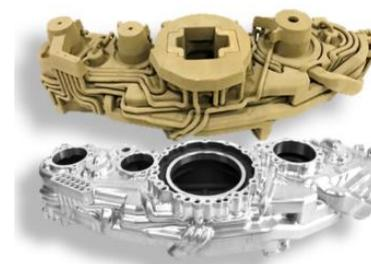
アクセサリ・ギアボックスの3Dプリンタ製砂型イメージ
