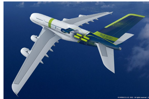
「エアバスZEROe」コンセプト図 (水素燃料電池によるプロペラ駆動) 出典:エアバス社HP
