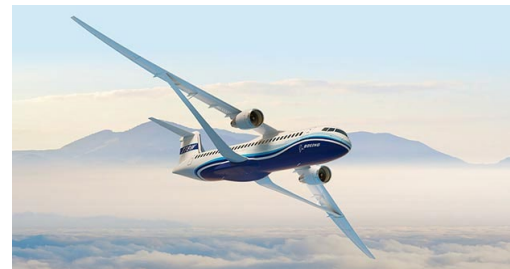
TTBW機 イメージ図 (巡航速度Mach 0.8、対MAX 30%の燃費削減) 出典:ボーイング社HP
