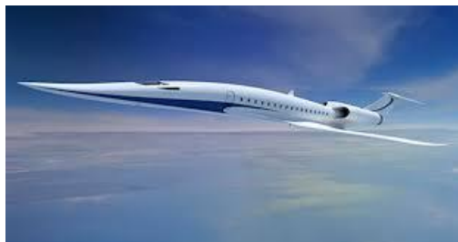
小型超音速旅客機概念 (M1.6、36~50PAX、3500nm)
