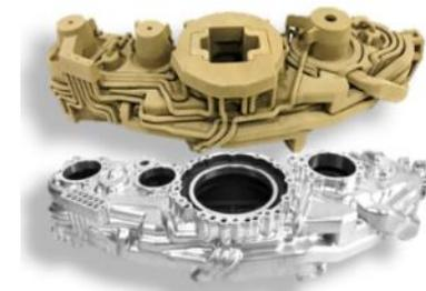
アクセサリ・ギアボックスの3Dプリンタ製砂型イメージ
