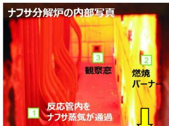
約850℃でナフサ熱分解している炉の熱源をアンモニアに転換
