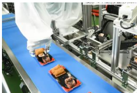
世界初の 惣菜盛り付け 自動化ロボット
