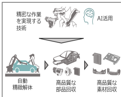
事業イメージ：自動車の精緻解体
