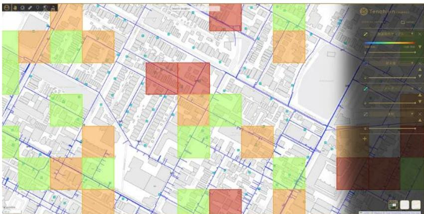
システムのサンプル画像。水道管の漏水リスクを表示
