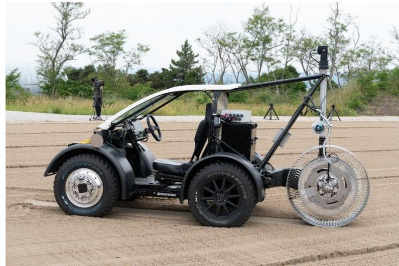
走行性能試験車両。背後の金属製タイヤが第2世代タイヤのスケールモデル
