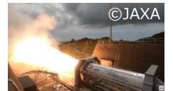
©JAXA 固体ロケットブースターの燃焼試験
