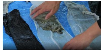
AMELTIS®で縫製したダウンウェアを熱水分解し羽毛を取り出すときの様子
