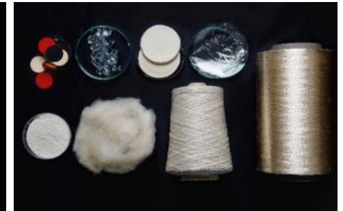
(左) Spiberがゴールドウインと共同開発した「ムーンパーカ」 (右) 人工構造タンパク質「Brewed Protein™(ブリュード・プロテイン™)」の加工例（繊維、樹脂、ゲル、スポンジ、フィルム等）
