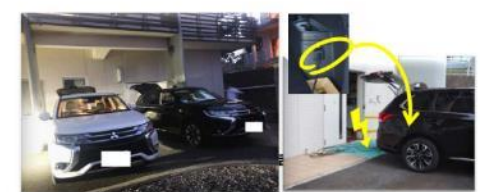
PHVからの給電：老人ホームで洗濯機・洗濯乾燥機に使用 出典：三菱自動車工業株式会社
