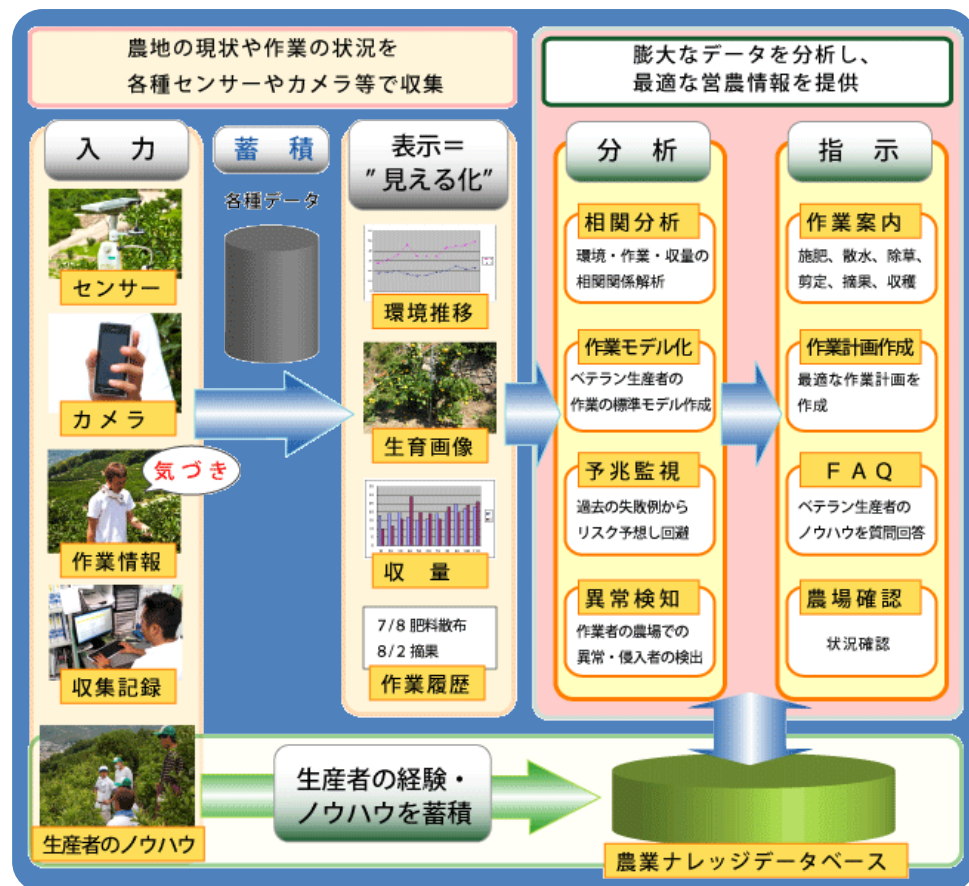
園地に設置したセンサーで、気温・降水量・土壌温度などのデータを一定間隔で収集
