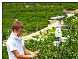
園地に設置したセンサーで、気温・降水量・土壌温度などのデータを一定間隔で収集
