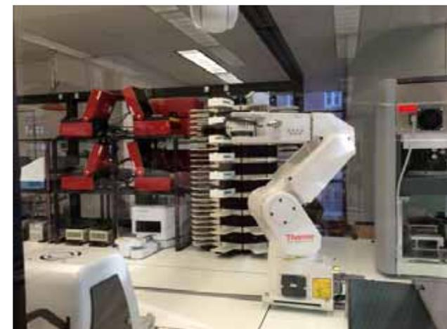
U Illinois: 構築から培養、アッセイまですべてを自動化した合成生物システム (iBioFAB)
