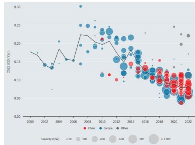
図12 世界の洋上風力発電プロジェクトのサイズとLCOE（加重平均）の推移
