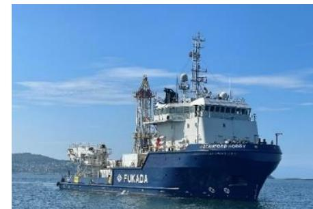
写真1 調査船（コーン貫入試験、PS検層に使用）
