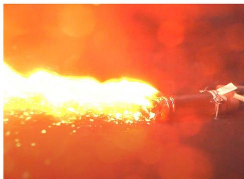
リチウムイオンバッテリーのセルが発火した様子
